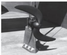
Hình 4.5. Cánh khuấy trộn đều bọt khí và tạo dòng chảy trong mương
