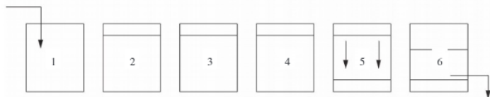
Hình 8.22. Vận hành bể SBR xử lý cacbon, nitơ và photpho
